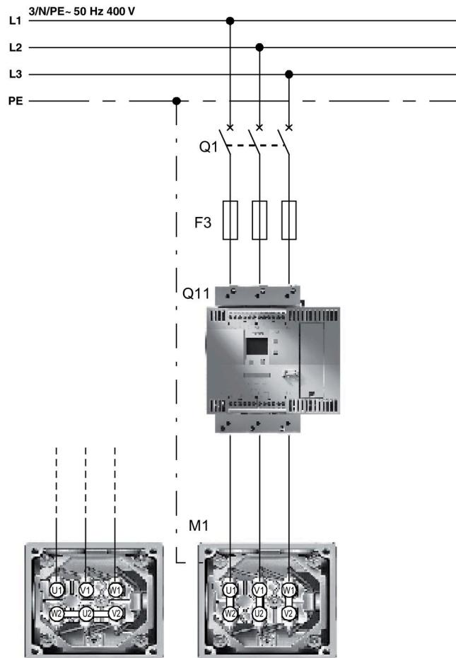
Рисунок 4-7 Принципиальная схема фидера с предохранителями для защиты полупроводников
