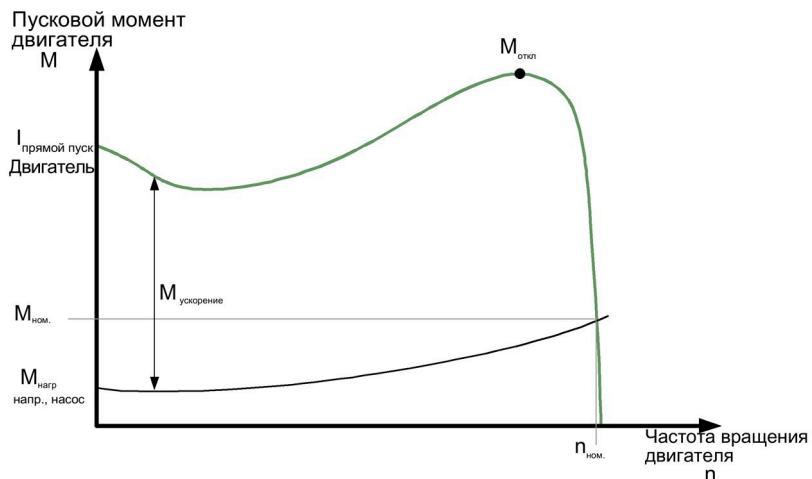
Рисунок 2-2 Типовая характеристика пускового вращающего момента трехфазного асинхронного двигателя
