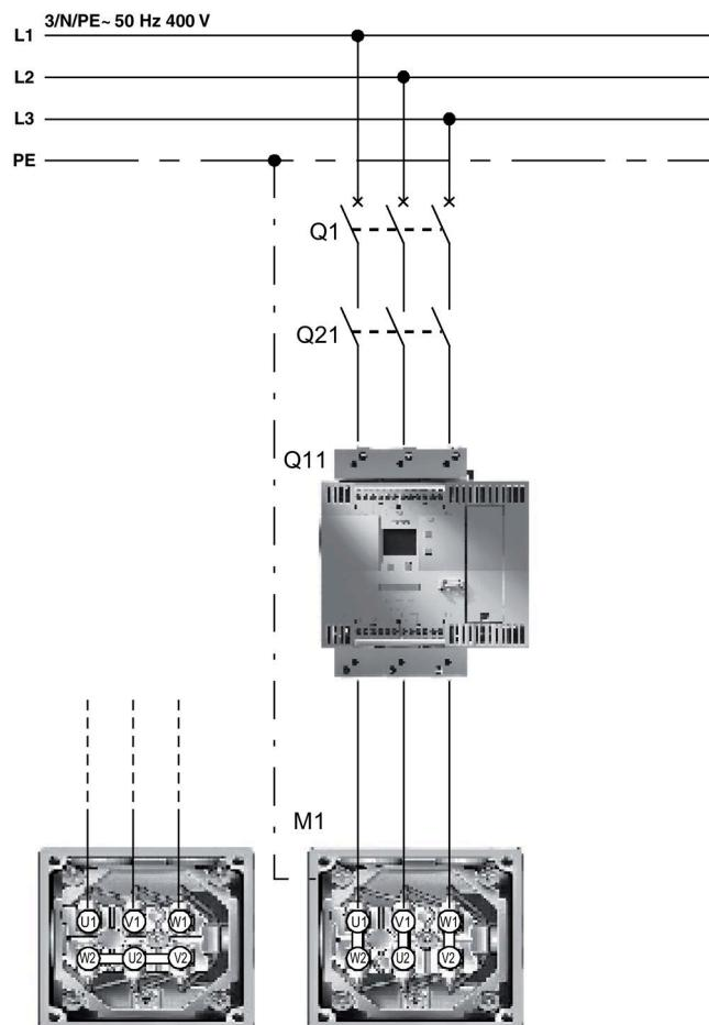
Рисунок 4-6 Принципиальная схема фидера с опциональным главным/сетевым контактором
