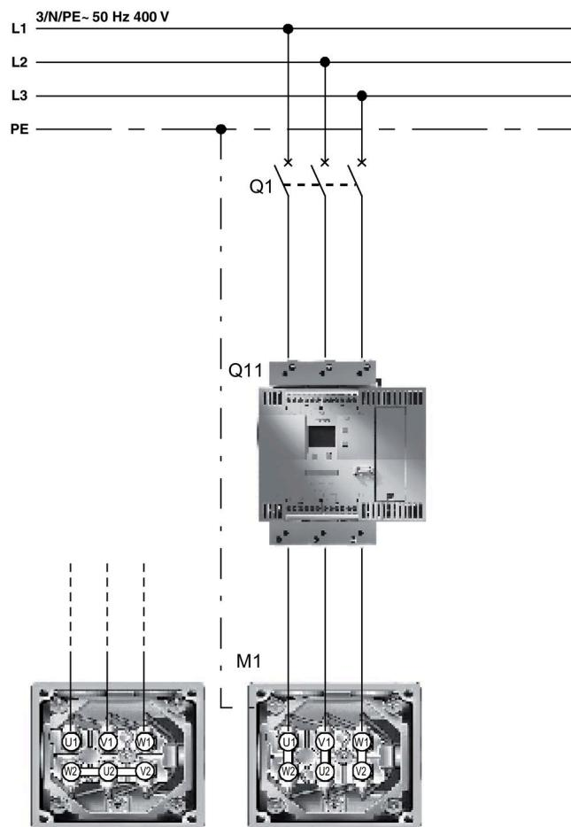
Рисунок 4-3 Принципиальная схема УПП 3RW44 со стандартным подключением
