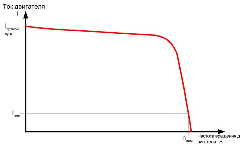
Рисунок 2-1 Типовая характеристика пускового тока трехфазного асинхронного двигателя
