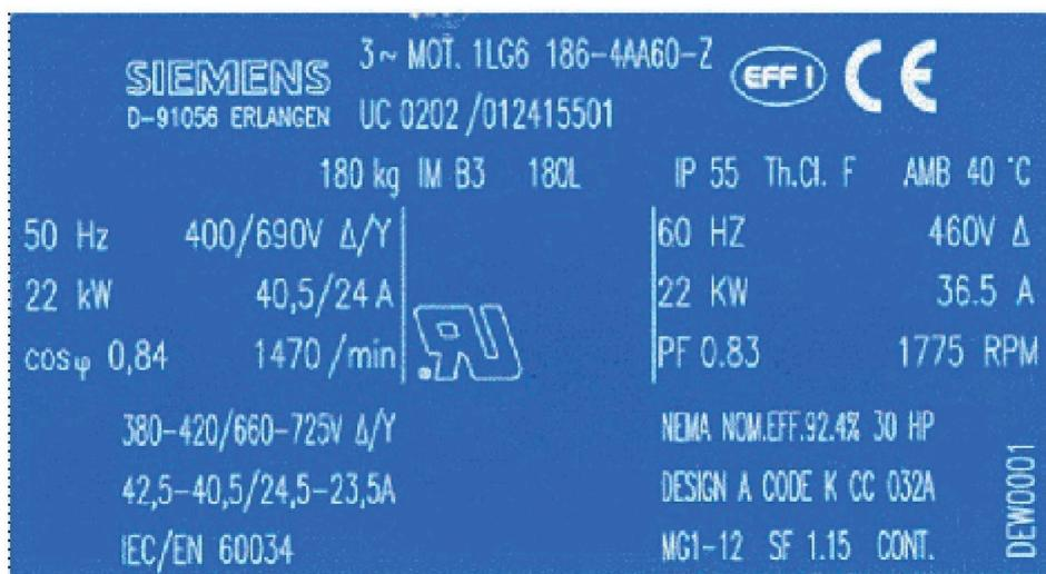
Рисунок 4-4 Заводская табличка двигателя 22 кВт
