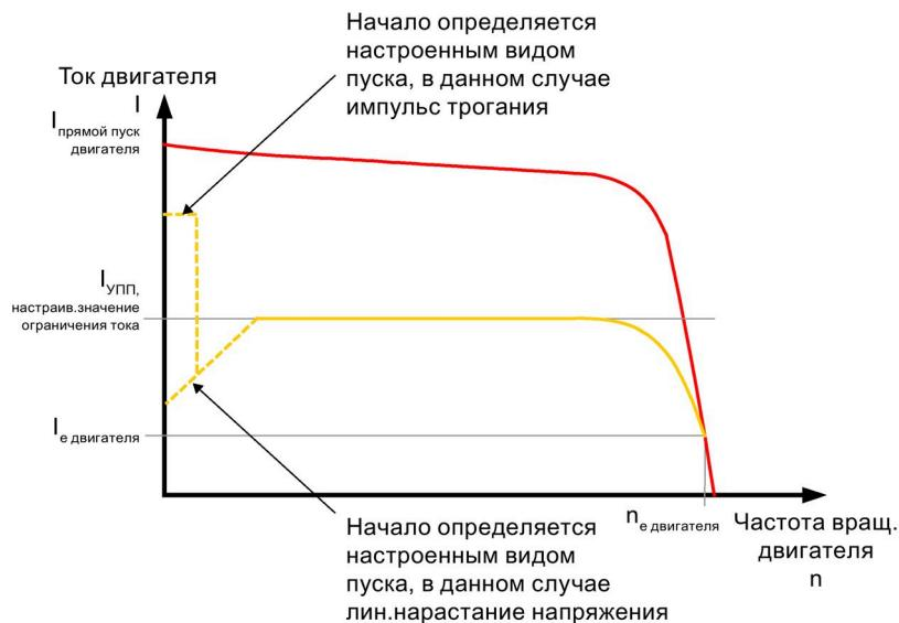
Рисунок 7-5 Ограничение тока с устройством плавного пуска
