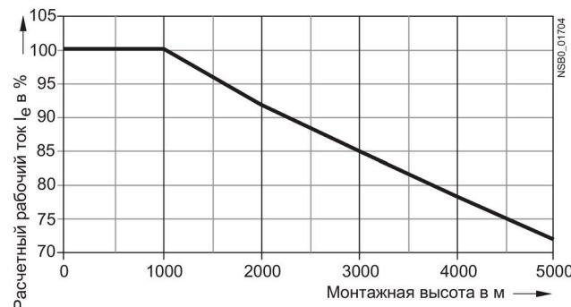
Рисунок 3-2 Снижение в зависимости от высоты места установки
