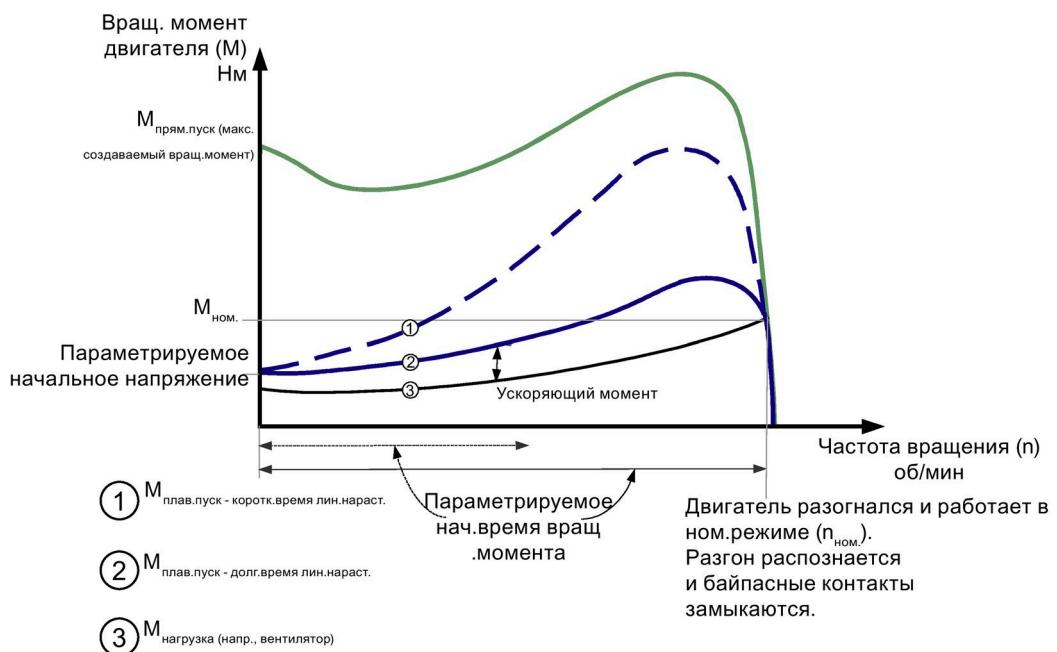
Рисунок 7-2 Принцип действия плавного пуска с линейным нарастанием напряжения, механическая характеристика
