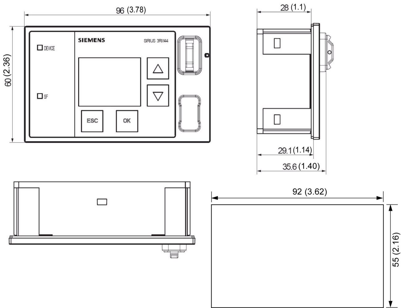
Рисунок 11-4 Внешний модуль индикации и управления 3RW49 00-0AC00
