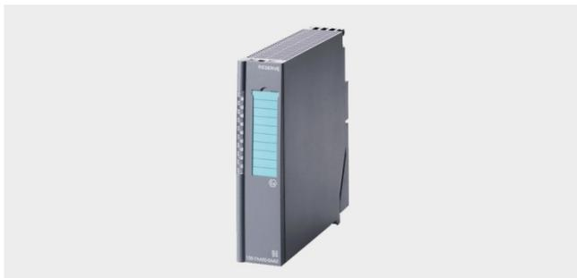
Ложные модули используются для резервирования посадочных мест, на которые впоследствии будут устанавливаться другие электронные модули. Ложный модуль не имеет связи с клеммами подключения внешних цепей терминального модуля. Поэтому монтаж внешних цепей может быть выполнен задолго до установки соответствующего электронного модуля.
